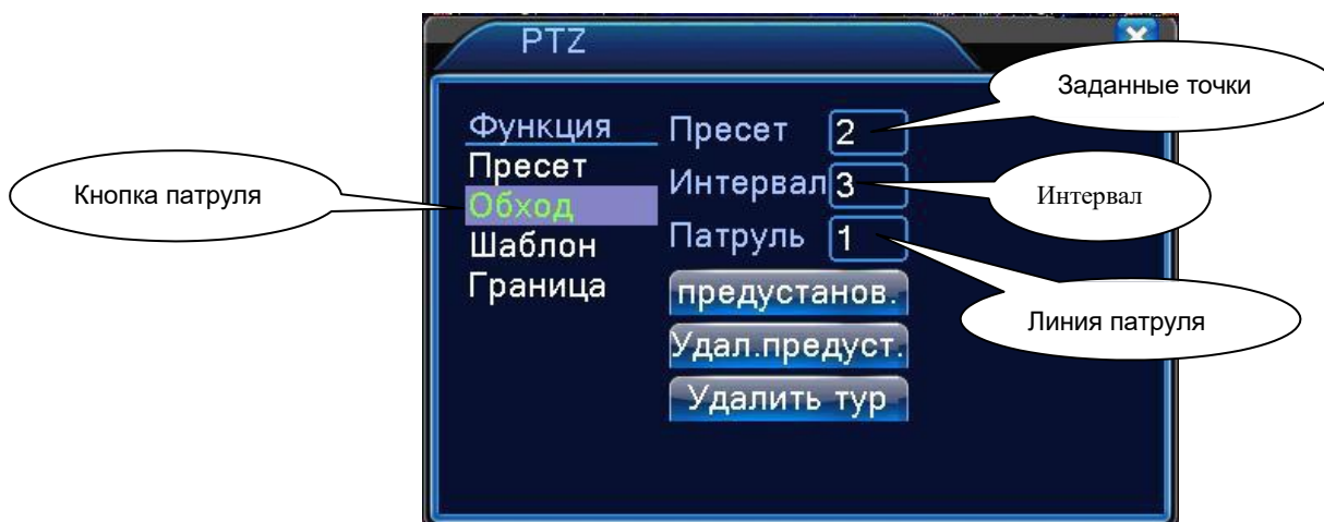
Рисунок 3.13 Настройки движения между точками
